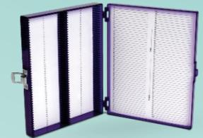
Fabricadas en plásticos ABS, sirve para sostener laminillas en forma vertical, con numeración en revestimiento y ranuras, con forro de corcho y cierre a presión.
