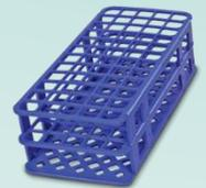
De polipropileno reforzado con fibra de vidrio, con separadores de tubo tipo clavija que permite visualizar el contenido del tubo, se usa como rack de secado para tubo, placas de vidrio, orificios en la base para soporte de tubos o drenaje en el secado, autoclavable.
