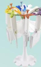
Compatible con casi todas las marcas. Fabricado en plásticos ABS no autoclavable, cada paquete contiene un soporte superior e inferior, el superior se puede agregar o quitar para adaptarse al ajuste de diferentes anchos de las pipetas. Permite mantener las pipetas en posición vertical para disminuir la contaminación cruzada.
