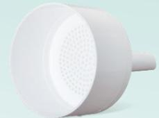
Autoclavable, de polipropileno, con paredes lisas y cono en ángulo de 60° y deflectores externos para evitar el bloqueo de aire
