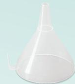
Autoclavable, de polipropileno traslúcido con válvula en PTFE, utilizado para decantación de líquidos.
