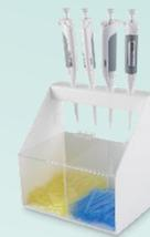
Soporte inclinado para 5 micropipetas en acrílico; diseñado para contener la mayoría de las marcas de pipetas más importantes.
